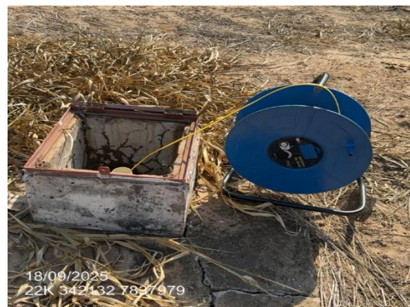
Figura 6.2-1: Medição dos poços do Programa de Monitoramento de Água Subterrânea: Nível d'Água do PM01A ao PM06A, respectivamente, da PCH Areado, Chapadão do Sul, MS. 2025.
