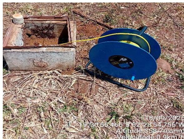
Figura 6.2-1: Medição dos poços do Programa de Monitoramento de Água Subterrânea: Nível d'Água do PM01A ao PM06A, respectivamente, da PCH Areado, Chapadão do Sul, MS. 2025.
