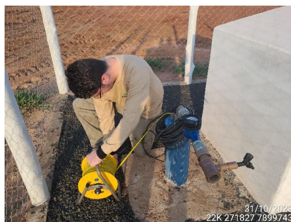
Figura 6.2-1: Medição dos poços para o Programa de Monitoramento do Nível de Água Subterrânea. Poços PM04-JU-MD e PM05-JU-ME, respectivamente. Novembro de 2023.
