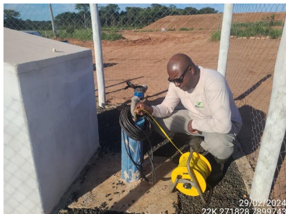
Figura 6.2-2: Medição dos poços para o Programa de Monitoramento do Nível de Água Subterrânea. Poços PM04-JU-MD e PM05-JU-ME, respectivamente. Fevereiro de 2024.
