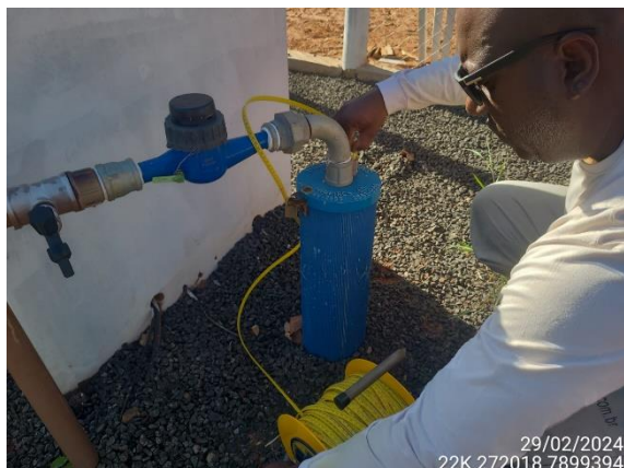
Figura 6.2-2: Medição dos poços para o Programa de Monitoramento do Nível de Água Subterrânea. Poços PM04-JU-MD e PM05-JU-ME, respectivamente. Fevereiro de 2024.
