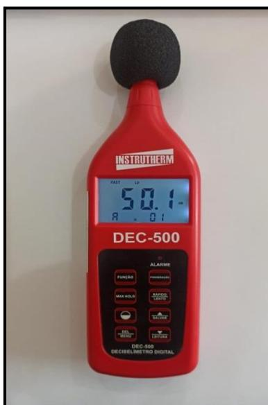
**Figura 1.** Aparelho Digital utilizado na medição de pressão sonora em campanha realizada no mês de dezembro de 2024, em 3 pontos localizados na área de influência da Unidade **PCH Fundãozinho, Rio Sucuriú**, localizada no município de Paraíso das Águas/MS. Fonte: MS, 2024.
