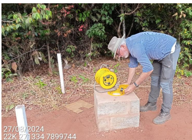
Figura 6.2-3: Medição dos poços para o Programa de Monitoramento do Nível de Água Subterrânea. Poço PM01-MO-MD, respectivamente. Agosto de 2024.
