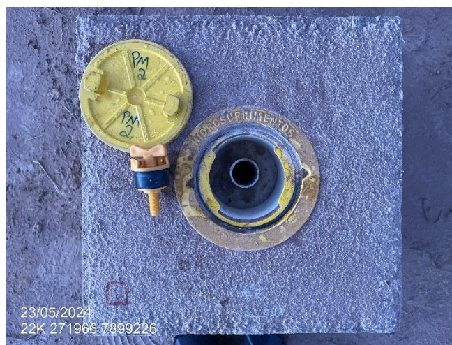
Figura 6.2-2: Medição dos poços para o Programa de Monitoramento do Nível de Água Subterrânea. Poço PM02-MO-MD, respectivamente. Maio de 2024.
