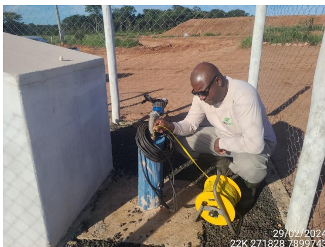
Figura 6.2-1: Medição dos poços para o Programa de Monitoramento do Nível de Água Subterrânea. Poços PM04-JU-MD e PM05-JU-ME, respectivamente. Fevereiro de 2024.
