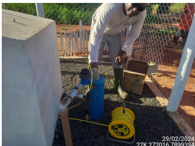
Figura 6.2-1: Medição dos poços para o Programa de Monitoramento do Nível de Água Subterrânea. Poços PM04-JU-MD e PM05-JU-ME, respectivamente. Fevereiro de 2024.
