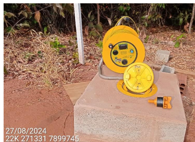
Figura 6.2-3: Medição dos poços para o Programa de Monitoramento do Nível de Água Subterrânea. Poço PM01-MO-MD, respectivamente. Agosto de 2024.
