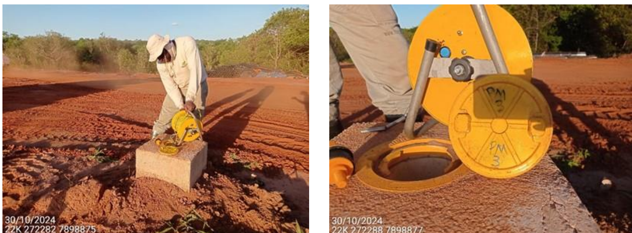
Figura 6.2-4: Medição dos poços para o Programa de Monitoramento do Nível de Água Subterrânea. Poço PM03-MO-MD, respectivamente. Novembro de 2024.
