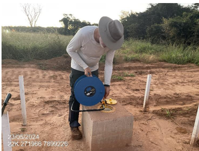
Figura 6.2-2: Medição dos poços para o Programa de Monitoramento do Nível de Água Subterrânea. Poço PM02-MO-MD, respectivamente. Maio de 2024.
