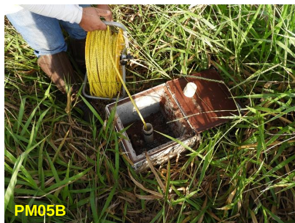
Figura 4. Medição dos poços de monitoramento 03, 04 e 05 de nível de água subterrânea existentes na PCH Bandeirante. Fonte: Samorano Consultoria Ambiental, 2020.
