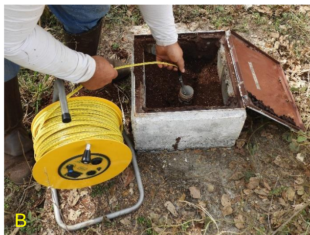
Figura 2. Medidor de nível de lençol freático utilizado nas campanhas. Fonte: Samorano Consultoria Ambiental, 2020.
