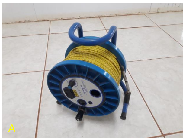
Figura 2. Medidor de nível de lençol freático utilizado nas campanhas. Fonte: Samorano Consultoria Ambiental, 2020.
