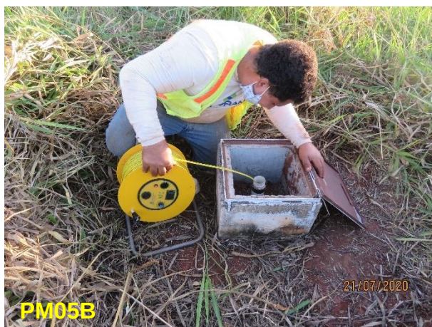
Figura 4. Medição dos poços de monitoramento 03, 04 e 05 de nível de água subterrânea existentes na PCH Bandeirante. Fonte: Samorano Consultoria Ambiental, 2020.
