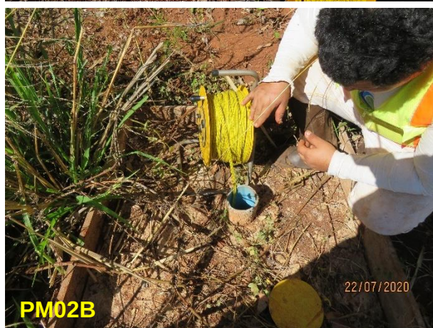
Figura 3. Medição dos poços de monitoramento 01 e 02 de nível de água subterrânea existentes na PCH Bandeirante. Fonte: Samorano Consultoria Ambiental, 2020.
