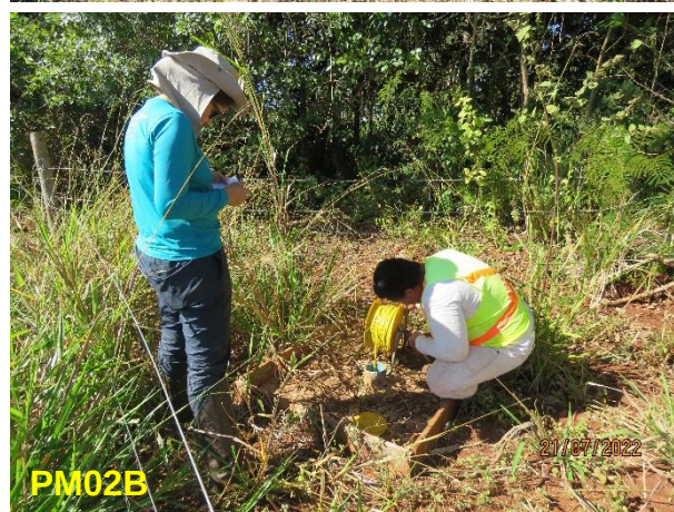
Figura 3. Medição dos poços de monitoramento 01 e 02 de nível de água subterrânea existentes na PCH Bandeirante. Fonte: Samorano Consultoria Ambiental, 2020.
