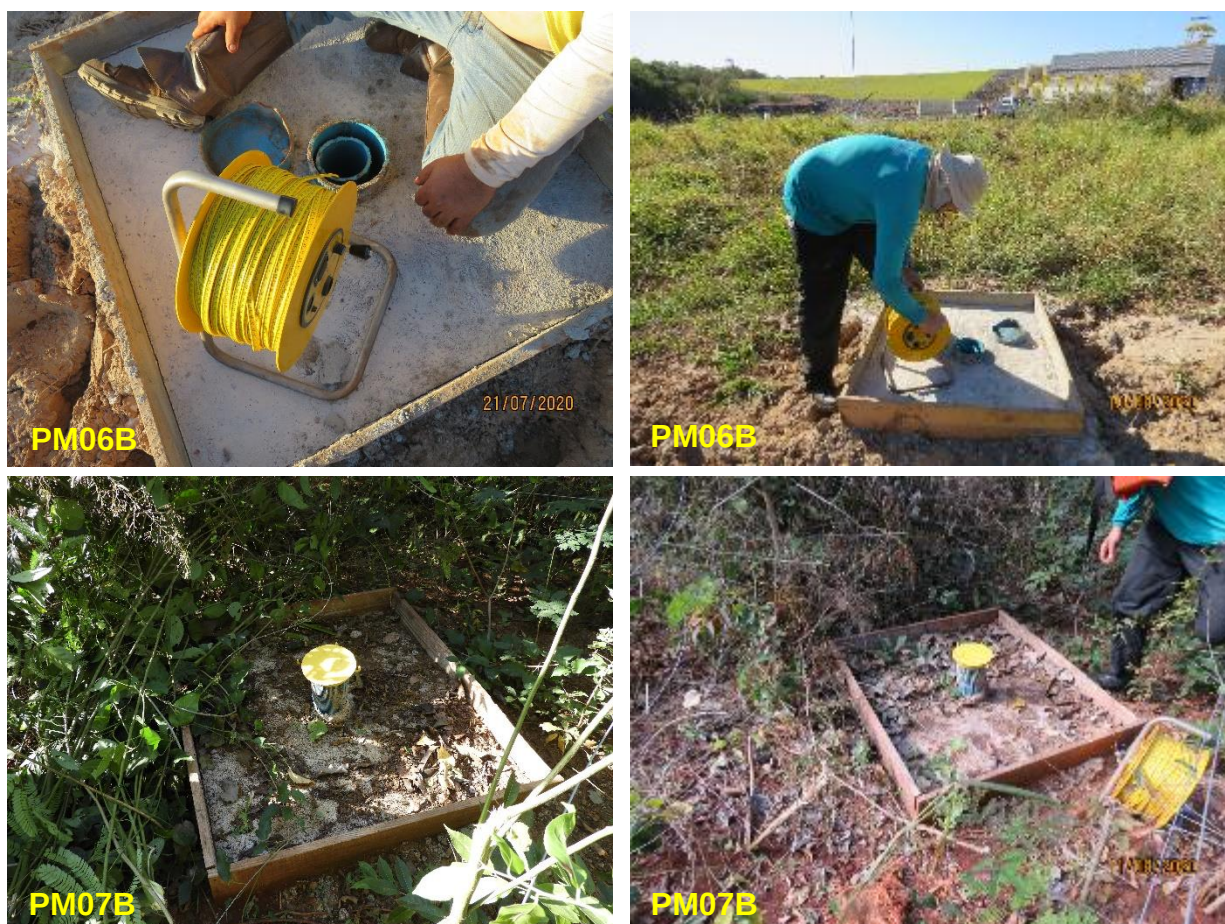
Figura 5. Medição dos poços de monitoramento 06 e 07 de nível de água subterrânea existentes na PCH Bandeirante. Fonte: Samorano Consultoria Ambiental, 2020.
