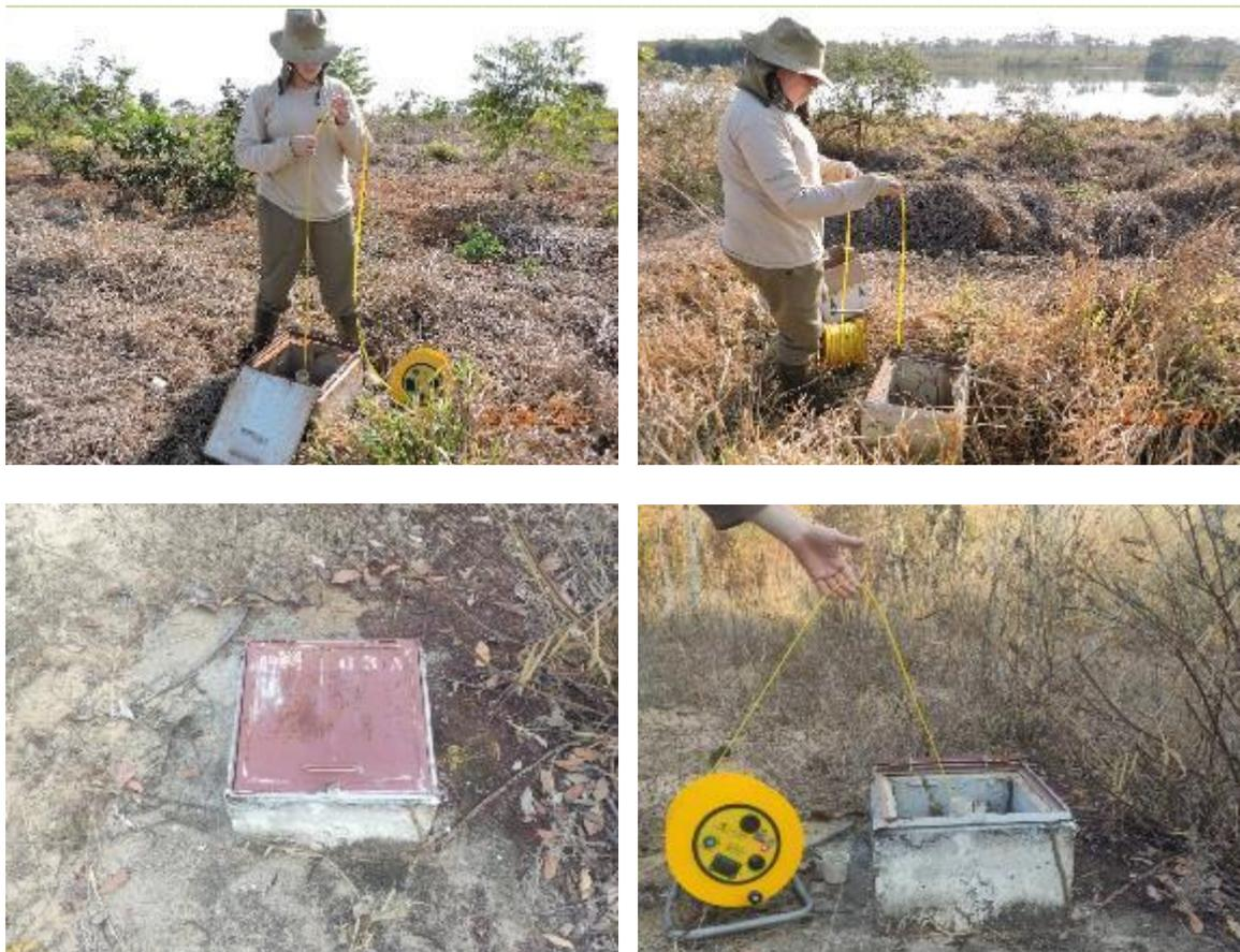
**Figura 4.** Medição dos poços do Programa de Monitoramento d'Água Subterrânea: Nível d'Água da PCH Areado, Chapadão do Sul, MS. Agosto de 2021.
